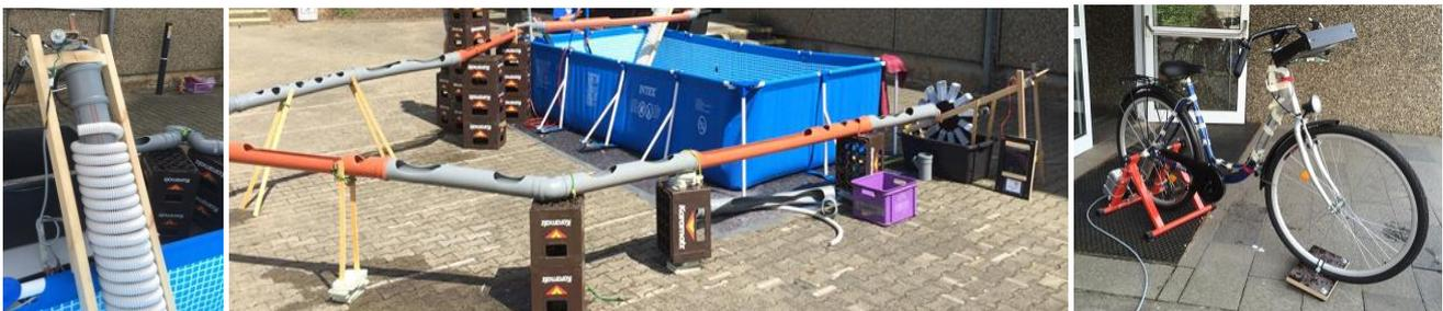
Erste Eindrücke: Das Wasserkraftanlagebecken und das bei den Kindern ziemlich beliebte „Fahrrad“, für dessen Antrieb es aber einer Menge Muskelkraft bedurfte, um über einen angeschlossenen Generator Strom zu erzeugen und so für Bewegung im Wasserkraftbecken zu sorgen.
